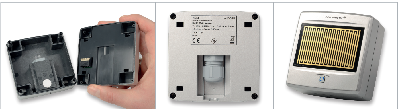
Bild 20: Die beiden Gehäusehälften werden zusammengesetzt und mit vier Schrauben verschraubt. Rechts das fertig montierte Gerät (hier ohne Anschlusskabel).
