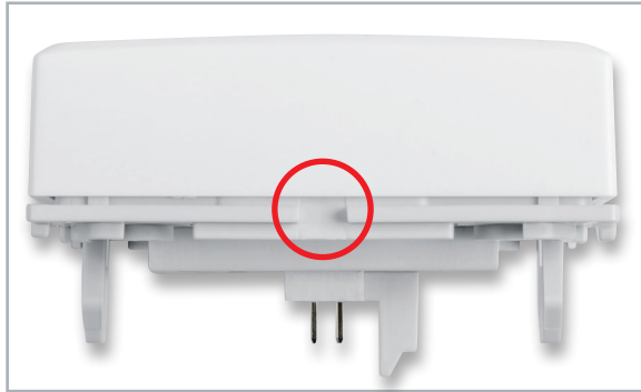
Bild 17: Die Kappe muss an allen vier Seiten einrasten.
