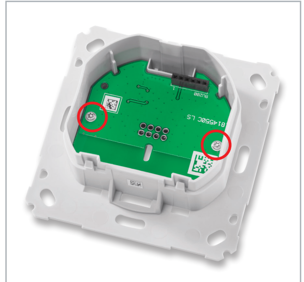
Bild 18: Die Treiberplatine wird zunächst mit zwei Schrauben (1,8 x 6 mm) befestigt ...
