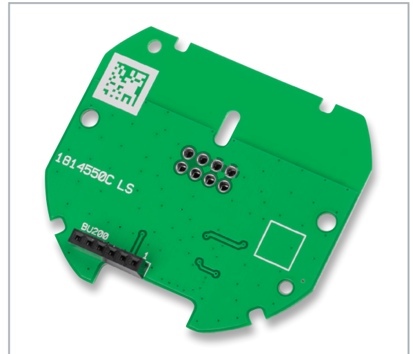
Bild 13: Die Treiberplatine mit der bestückten Buchsenleiste BU200
