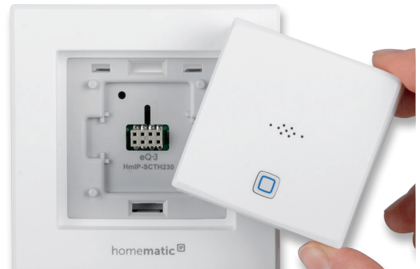
Bild 26: ... wird die Aufputzeinheit aufgesteckt und das Gerät kann in Betrieb gehen.
