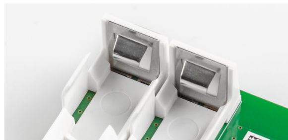
Bild 10: Einsetzen der Batteriehalter
