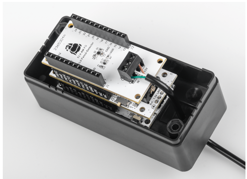
Bild 16: Anschluss des Kabels an das Applikationsmodul
