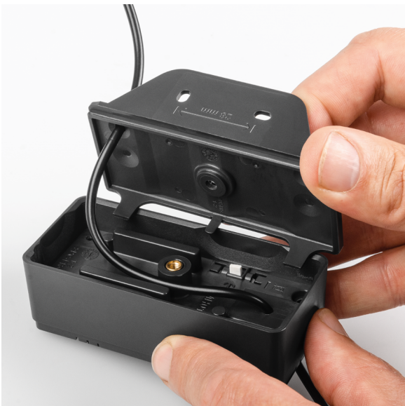
Bild 15: Einführen des Kabels in das ELV-Modulgehäuse
