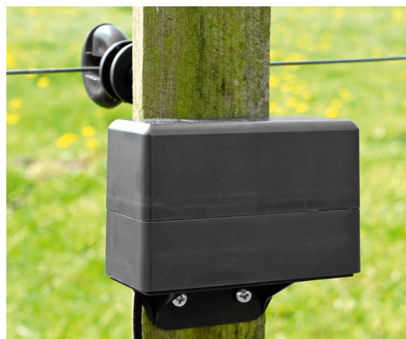
Bild 20: Befestigung der Basiseinheit an einem Weidezaunpfahl
